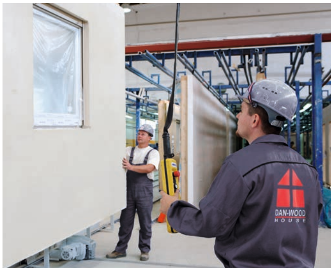
Die Wände werden in der Fabrik vorgefertigt...
